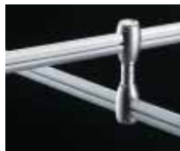
Kreuzverbinder 90° – 270° cross connector 90° – 270° raccord en croix 90° – 270° Schienenverlauf übereinander Schienenversatz 72 mm tracks cross over one another track offset 72 mm rails posés l'un sur l'autre écart entre les rails 72 mm 23135.46
